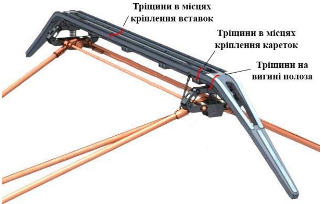
Рисунок 12 – Характерні несправності полз струмоприймача
