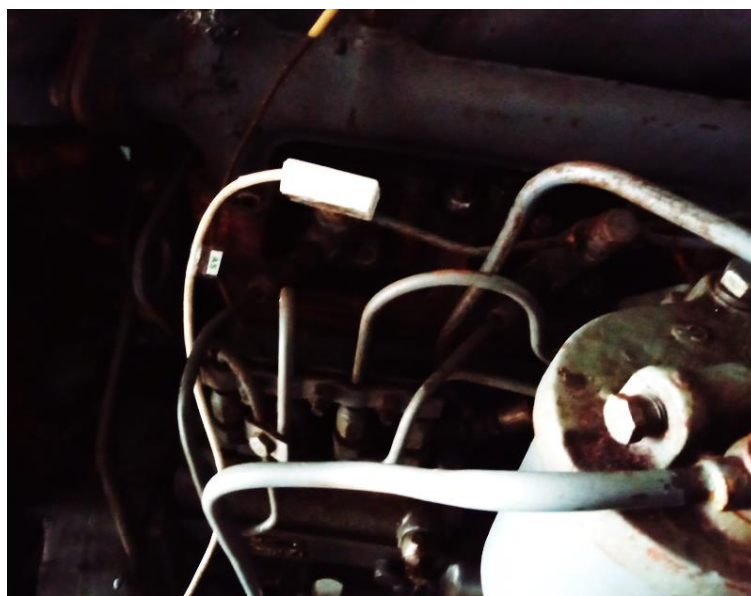
Рисунок 2.9 – Розташування датчику прискорень на форсунці дизельного двигуна
