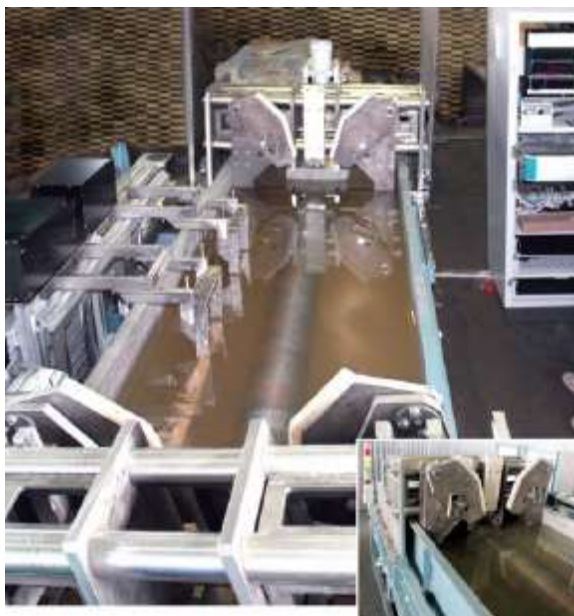
Рисунок 3.6 – Установка ультразвукового імерсійного контролю залізничних осей «Вісь-4» [15]
