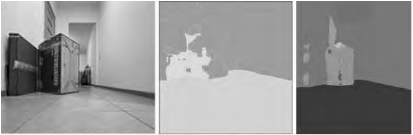
Fig. 3. Recognizing obstacles in the corridor using: a – SSD classifier; b – UNET segmentation; c – Deeplab segmentation / Розпізнавання перешкод у коридорі за допомогою: а – класифікатора SSD; б – сегментації UNET; в – сегментації Deeplab
