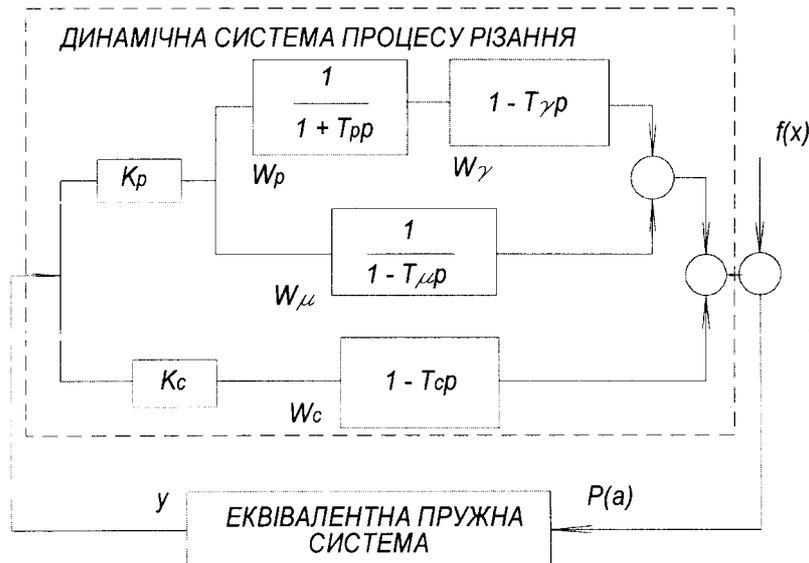
Рис. 8. Структурна схема динамічної системи верстата з процесом різання
