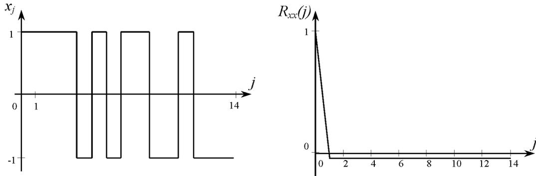
Рис. 1. П'ятнадцятиелементна  $M$ -послідовність та її автокореляційна функція
