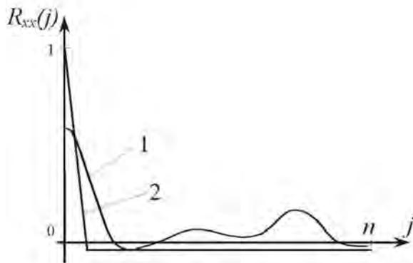
Рис. 3. Автокореляційна функція рандомізованого сигналу
