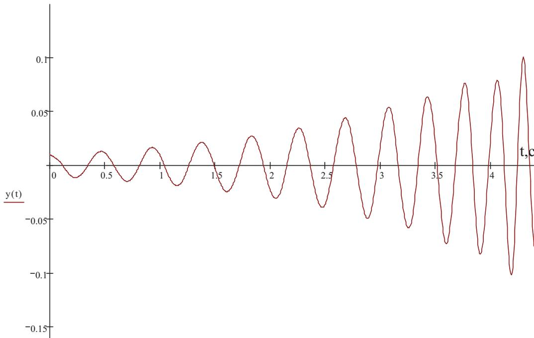
Рис. 3. Залежність амплітуди коливання сталеві нитки від часу ( $V = 20\sin(3t)$ )
