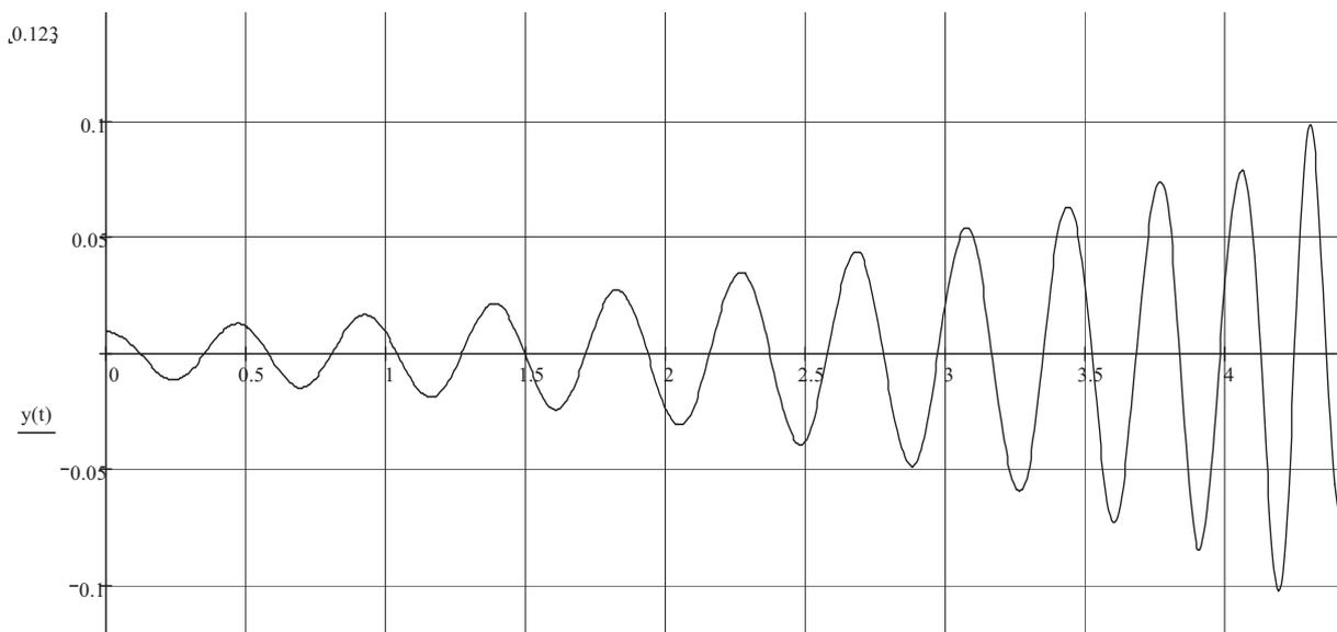
Рис. 2. Залежність амплітуди коливання сталеві нитки від часу ( $V = 20\cos(3t)$ )
