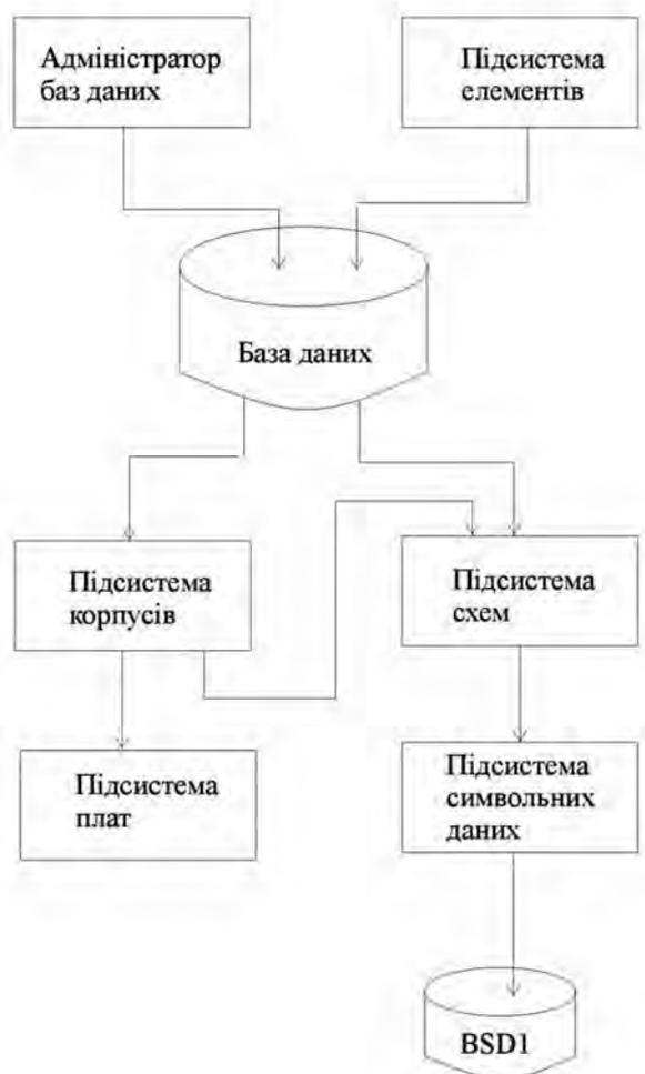
Рис. 2. Блок-схема інтегрованої системи ACCEL EDA
