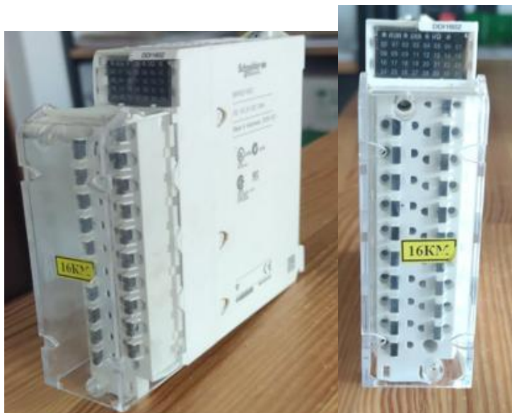
Рис. 3.20 Вигляд модуля, призначеного для дискретних входів BMX DDI-1602
