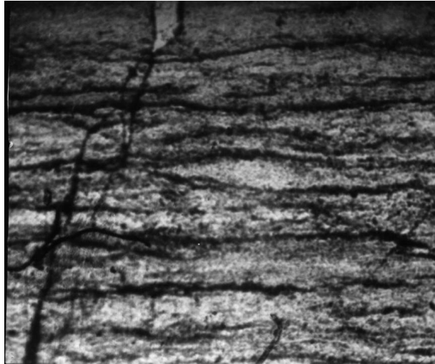
Рис. 4. Мікролінзочки і мікропрошарки розсіяної органічної речовини та заповнені епігенетичною органікою тріщини в основній масі породи, складеній крипто-, мікрокристалічним халцедоном. Фтаніт. Нижньоменілітова підсвіта, олігоцен. Львівська обл., р. Тисмениця, м. Борислав.
