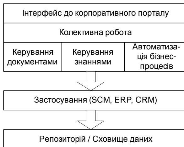
Рис. 1. Структура систем ЕСМ
