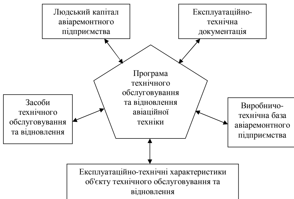
Рис. 1. Структура системи технічного обслуговування та відновлення АТ [7]
