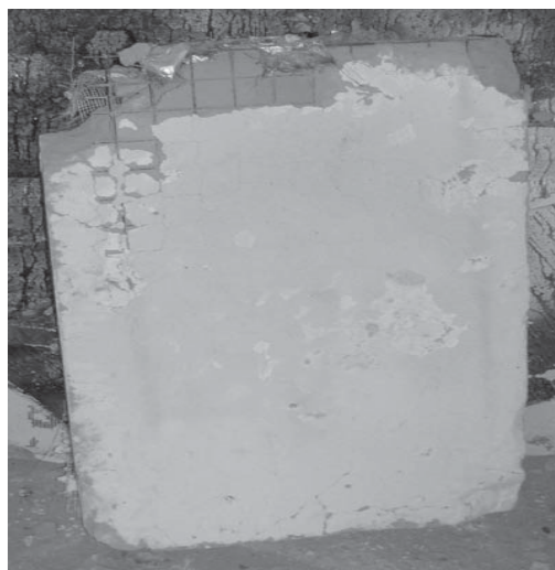
Рис. 5. Вигляд дослідного зразка марки СП-1 після випробування
