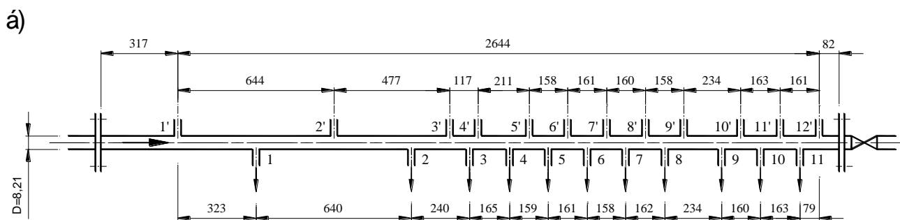
Рис. 2. Схеми експериментального розподільчого трубопроводу з різними значеннями шпаруватості f : 0,935 (а); 1,469 (б): 1-11 – водовипускні патрубки; 1'-12' – штуцери для приєднання гумових імпульсних трубок (розміри подані в мм)
