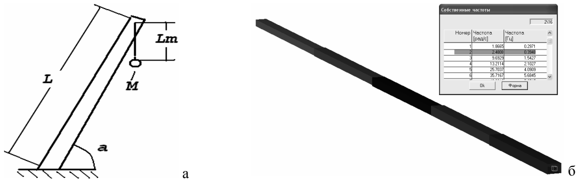
Рис. 3. Стріла пожежної машини: а – загальний вигляд; б – розрахункова схема в АРМ
