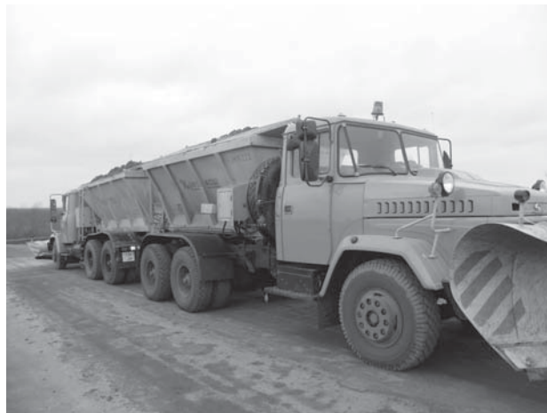
Рис. 2. Розташування машин для статичного випробовування прогонової будови
