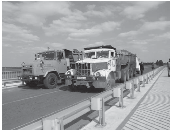
Рис. 6. Випробування шляхопроводу на км 261+441
