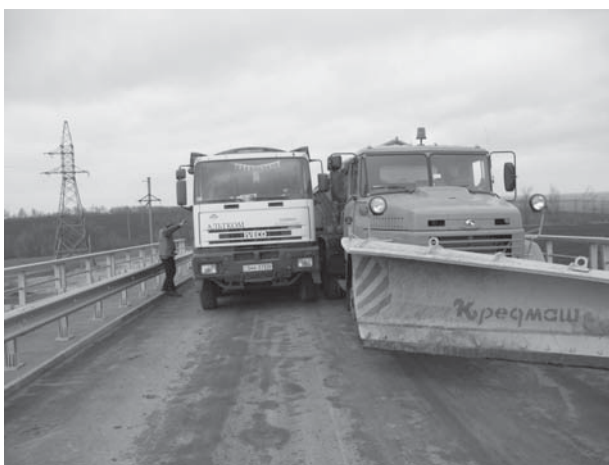
Рис. 2. Розташування машин для статичного випробовування прогонової будови
