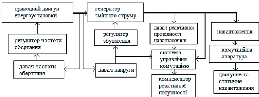
Рис. 4 - Структура математичної моделі автономної електроенергетичної системи з компенсацією реактивної потужності
