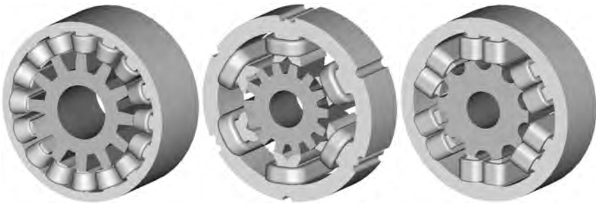
Рис. 1. Конструктивні схеми ЕМП ВРД
