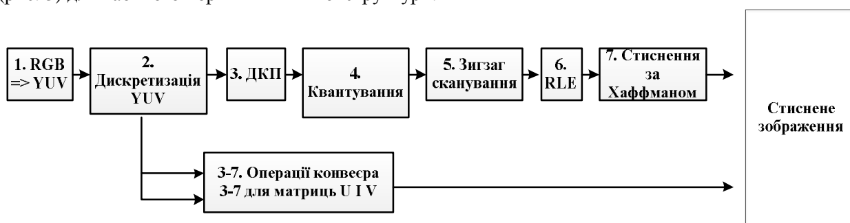
Рис. 1. Схема алгоритму стиснення зображень JPEG: ДКП – дискретне косинусне перетворення; RLE – Run Length Encoding – кодування зі змінною довжиною рядка
