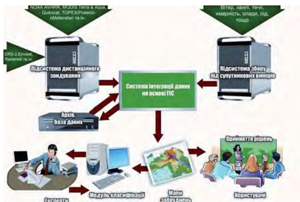
Рис. 1. Функціональна схема системи моніторингу атмосферного повітря
