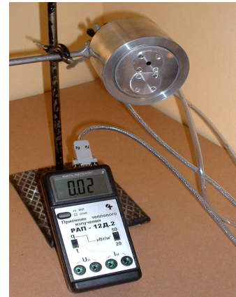
Рис. 2. Внешний вид прибора модели РАП-12Д.2: 1 – приемник теплового излучения; 2 – цифровое показывающее устройство
