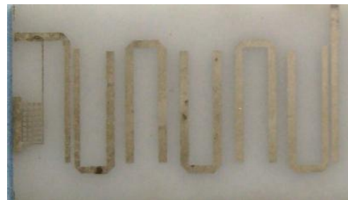
Рис. 2. Зовнішній вигляд мікроплати, яка містить фільтр на частоту 1,9 ГГц, виготовлений з використанням фотополімеризованої пасти 1785 на підкладці ВК100-1
