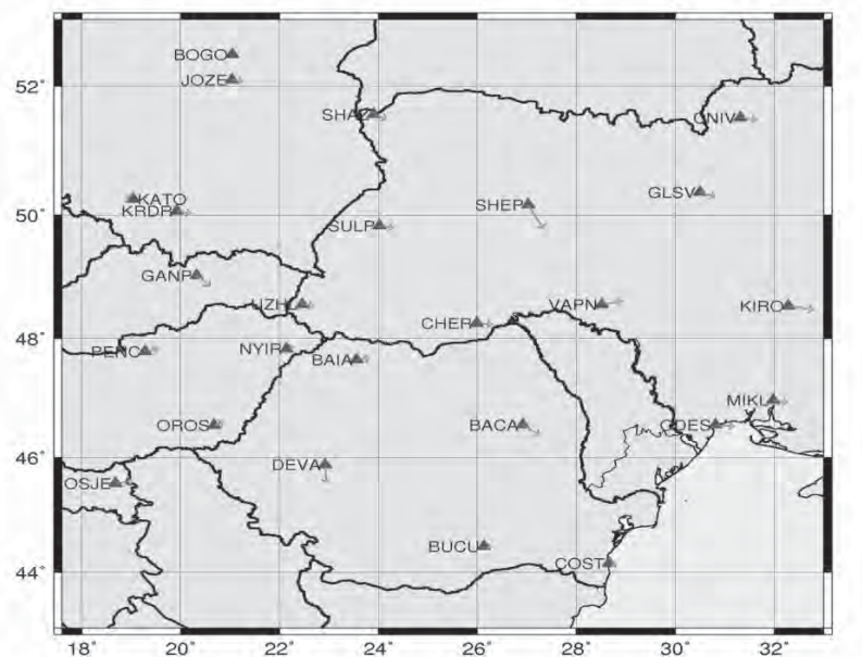
Рис. 5. Залишкові лінійні швидкості [мм/рік] згідно з даними 25 GPS-станцій [9]
