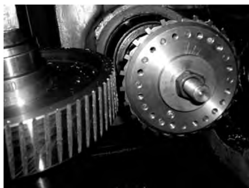
Рис. 1. Нарізання зубчастого колеса дисковою фрезою на зубофрезерному верстаті обкочуванням
