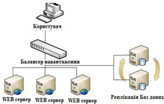
Рис. 4. Схема балансування навантаження у CDN мережі
