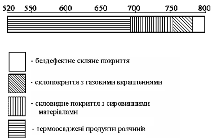
Рис. 1. Аналіз продуктів термоосадження розчину системи \text{Na}_2\text{O} - \text{SiO}_2 - \text{P}_2\text{O}_5 - \text{MoO}_3 в градієнтній печі
