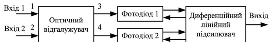
Рис. 5. Структурна схема амплітудно-фазового демодулятора
